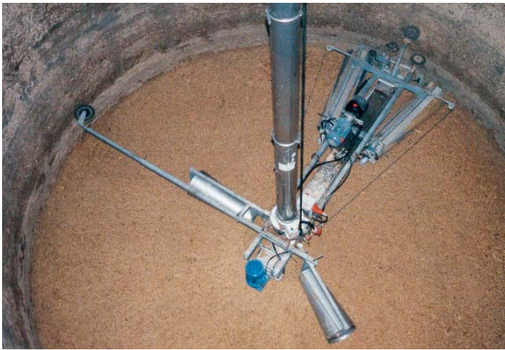
HMSB 600-Fräse im Entnahme-Einsatz bei Maishäcksel silage (Verteilen nicht möglich).
