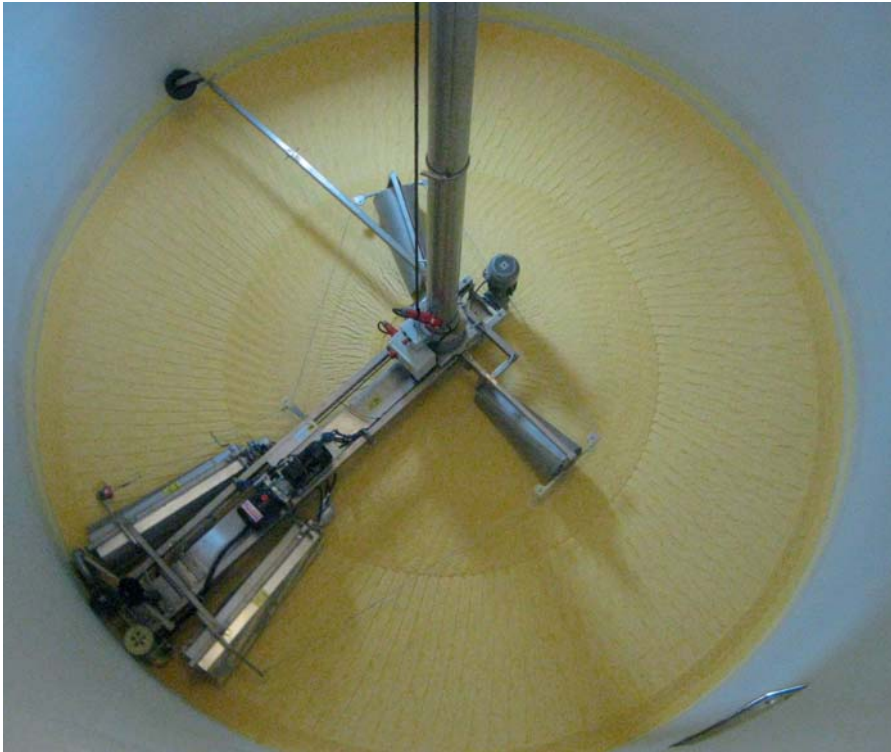
HMSB 500-Fräse (ø 5 m) beim Verteilen und Verdichten von CCM-Maiskornschrötsilage. Das eckige Teleskoprohr (siehe rechts) hält den Schleifring gegen Verdrehung zurück.
