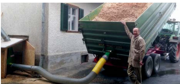
Rücksaugeinrichtung für Kipperanschluss
