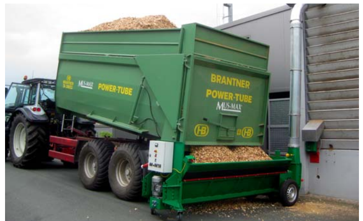
Troggebläse mit Elektromotor – ideal bis 30 Srm/h
