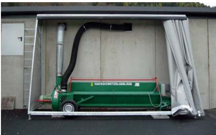
Troggebläse mit Rücksaugereinrichtung – staubfreie Arbeit
