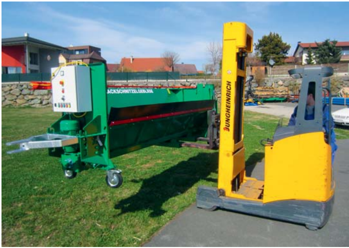
Troggebläse mit Stapler hantierbar – einfach zu verladen
