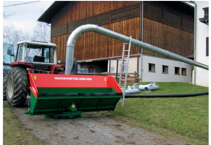
Traktorgebläse mit schwenkbarem Trog – hohe Förderleistung
