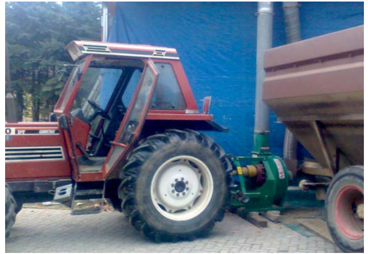
Traktorgebläse mit Saugereinrichtung – Containerbeschickung
